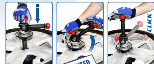
Le dispositif "Smart Lock", breveté GIULIANO, est simplement le Système de blocage de roue manuel le plus rapide au monde! Introduisez l'axe du "Smart Lock" dans le trou central de la roue, le faisant glisser dans le mandrin de blocage, et soulevez le levier. Moins de deux secondes pour obtenir un blocage parfait. Rapide et fiable, le collier à expansion, qui se trouve dedans, peut être enregistré par rapport aux exigences.
